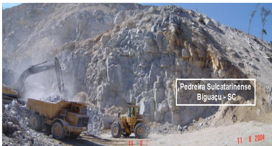
Figura 5.5 - Pedreira da Sulcatarinense – Biguaçu – SC, que explora um granito grosseiro, cinza claro e isótopo.
