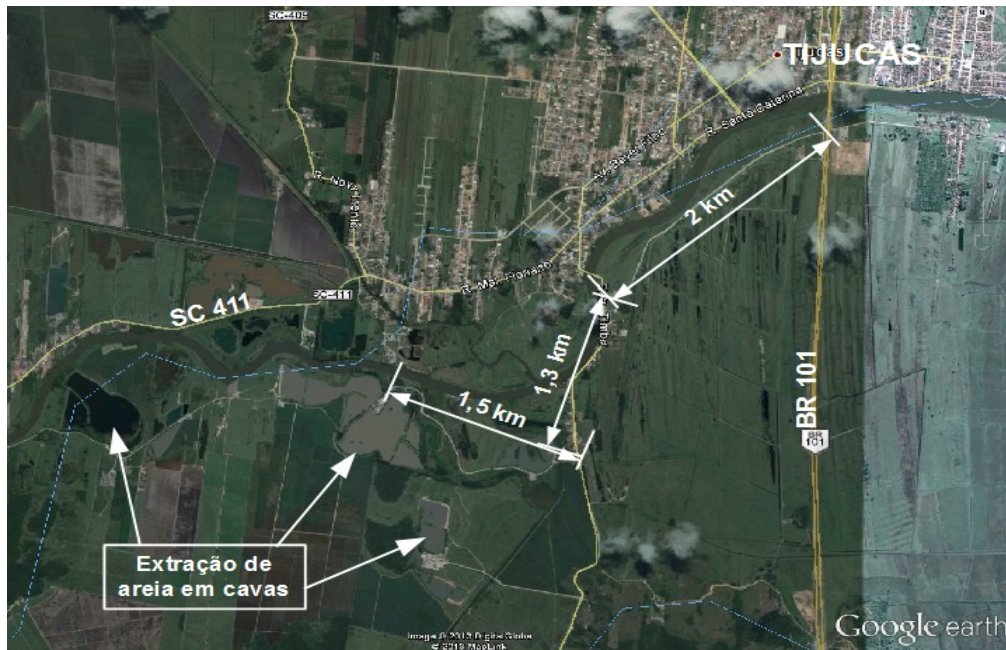
Figura 5.10 - Imagem com a localização das cavas de extração de areia, no leito abandonado do Rio Tijucas.
